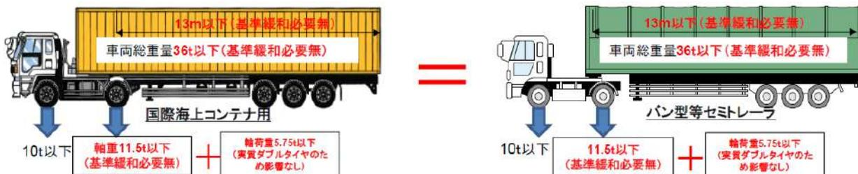
○特に重量貨物を積載する際には、最大積載量内であっても、集中荷重・偏心荷重になりがちです。軸重違反を防止するために、積付けにあたっては軸重・輪荷重が適正な状態となるように注意する必要があります。積荷全体の総合重心位置等を十分考慮して、重量配分することが必要です。適切な重量配分は、荷崩れの防止等、運行全体の安全確保にも役立つことも、運転者に周知しましょう。
