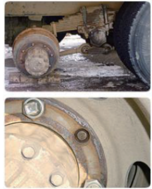
▲車輪脱落事故を起こしたタイヤ (出典：国土交通省 自動車点検・整備「車輪脱落事故」)
